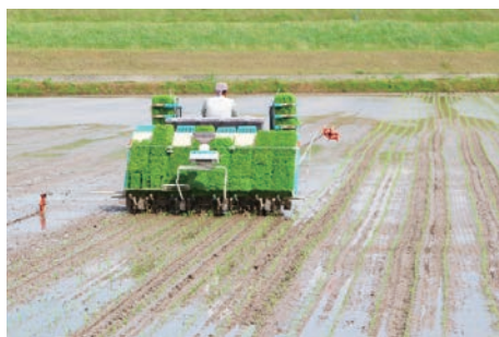
Cấy mạ bằng máy cấy mạ có người lái
