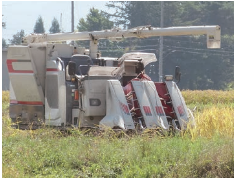
Thu hoạch bằng máy gặt đập liên hợp chuyên dụng cho lúa nước
