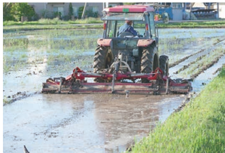
Cày ướn bằng máy kéo
