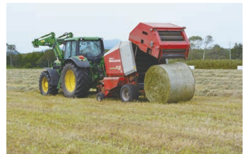
Công việc đóng gói sử dụng máy cuộn rơm cỏ
