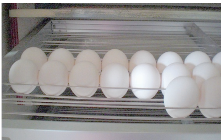
Trứng đã thụ tinh được đặt trên ngăn đặt trứng của máy ấp trứng.
